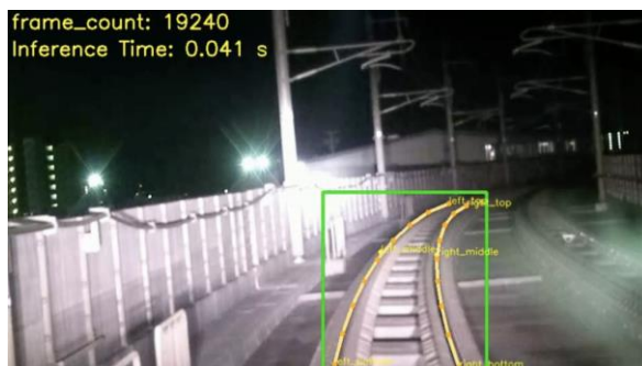
支障物検知 AI システム
