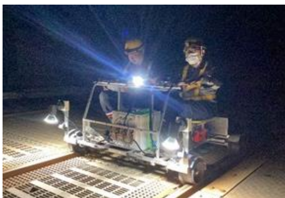
▲ カートによる線路巡視の様子
