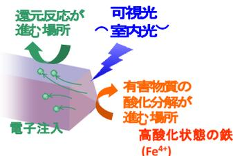
開発したナノ構造制御された光触媒粒子の先端だけに選択的に金属イオンを担持した電子顕微鏡写真と反応の模式図
