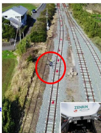
予め線路上空に設定した飛行経路を正確に飛行可能か検証
