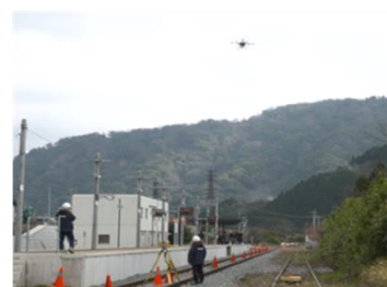
飛行中のドローンを測量
