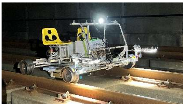
新幹線軌道モニタリング装置
