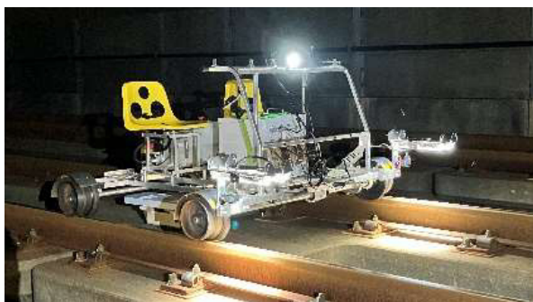
新幹線軌道モニタリング装置
