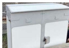
放射冷却素材「SPACECOOL」の実証試験
