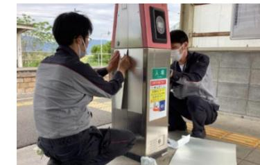
放射冷却素材「SPACECOOL」の実証試験
