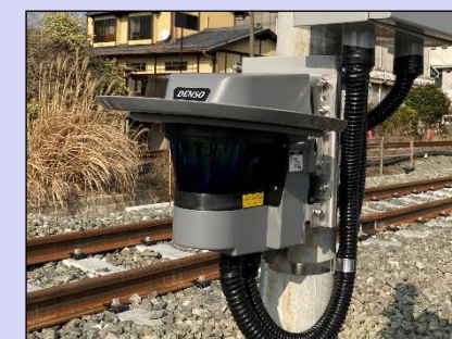
〔踏切障害物検知装置(2D式)〕
