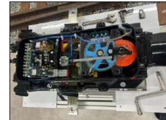
[内部構造可視化電気転てつ機]
