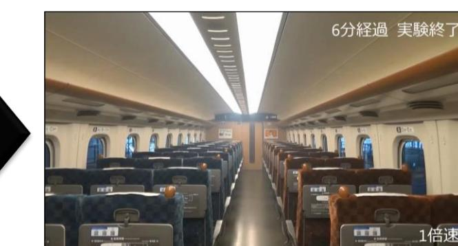
[空調装置による換気検証: 左: 煙充填時、右: 6分後の車内の様子]
