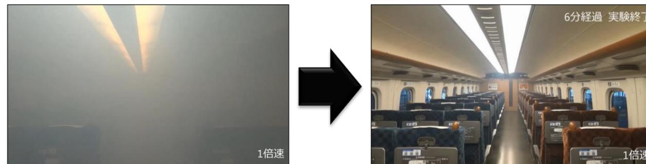
[空調装置による換気検証:左:煙充填時、右:6分後の車内の様子]
