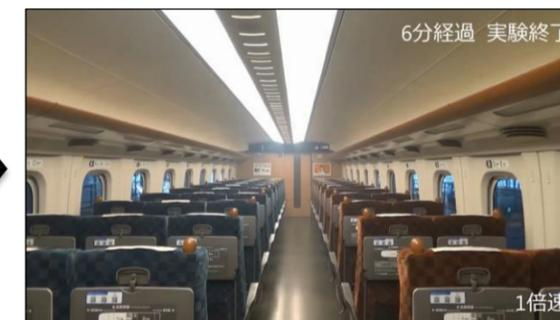
[空調装置による換気検証:左:煙充填時、右:6分後の車内の様子]
