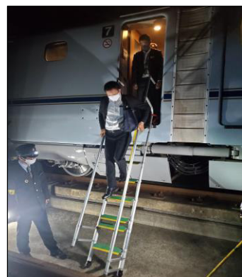
〔非常はしご設置〕
