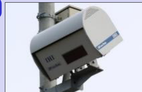
〔踏切障害物検知装置(3D式)〕
