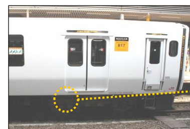
〔車両床下機器(車上子)〕
