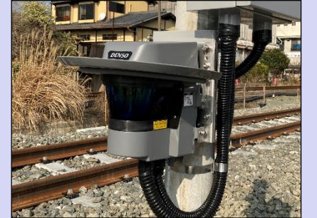
〔踏切障害物検知装置(2D式)〕
