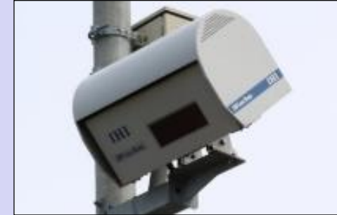
〔踏切障害物検知装置(3D式)〕
