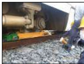
〔搬送仮台車設置訓練〕
