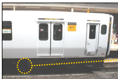
〔車両床下機器(車上子)〕
