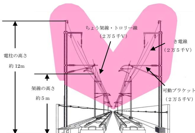
可動ブラケット・ちょう架線・トロリー線は電車線、き電線は高圧配電線です。
