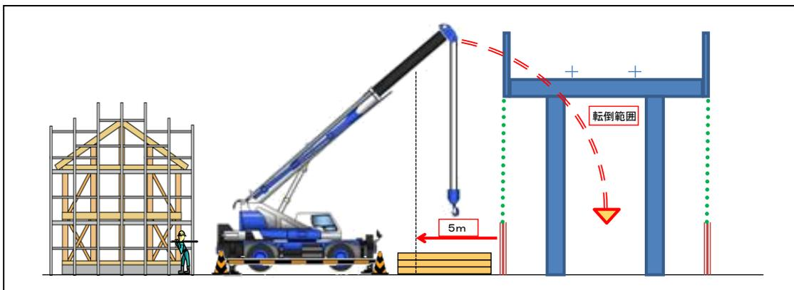
クレーンの旋回範囲・転倒範囲によっては、新幹線構造物への影響が考えられます。クレーンを使用する際は、地下埋設物の確認や敷鉄板を確実にし新幹線構造物側へ転倒しないようにしてください。
