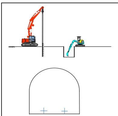
トンネル上部で、地質調査のためのボーリングや、重機械を使用しての掘削・杭打ち作業を行うと、新幹線のトンネルに影響を及ぼす恐れがあります。トンネル上部で、土被りが浅いところがあるため、必ず協議を行ってください。
