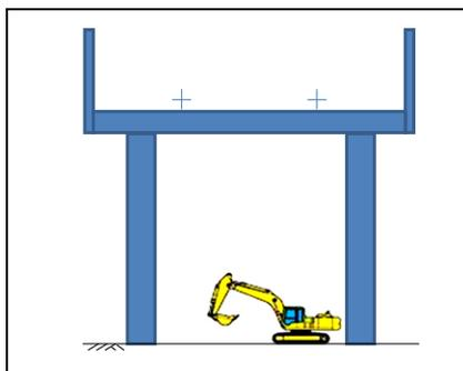
新幹線高架下で、重機械を使用して作業を行う場合は、重機械の規模・旋回範囲・移動等で新幹線構造物に接触する可能性があるため、協議前に新幹線構造物に接触させないための安全対策も含めて検討をしてください。なお、近接の範囲内で重機械を使用する場合は、保安要員【工事管理者（新幹線）・重機誘導員】の配置が必要です。
