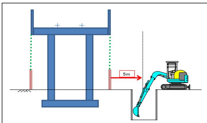
バックホウによる掘削作業を新幹線構造物に近接して行う場合、旋回範囲、掘削位置までの距離及び深さによっては、新幹線構造物に影響を及ぼす恐れがあります。また、新幹線構造物側へバックホウが転倒しないよう、必要により矢板を設置し掘削した側面が崩れないようにしてください。
