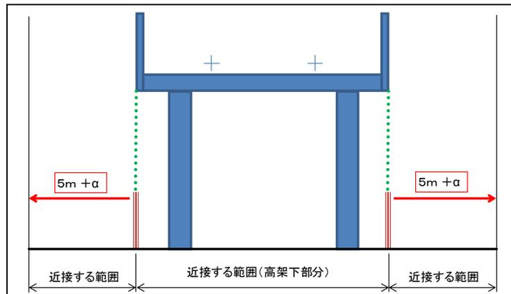
※ 境界線から概ね5m以内及び新幹線高架下部分は新幹線近接工事の範囲となり、この範囲内で重機械を使用して作業する場合はもちろん、重機械の転倒範囲内に新幹線構造物がある場合も協議が必要です。
