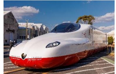
他にも、大容量リチウムイオンバッテリーによる“バッテリー自走システム”や地震時に緊急制動を行う地震ブレーキの採用により、災害時の安全性も向上しています。
