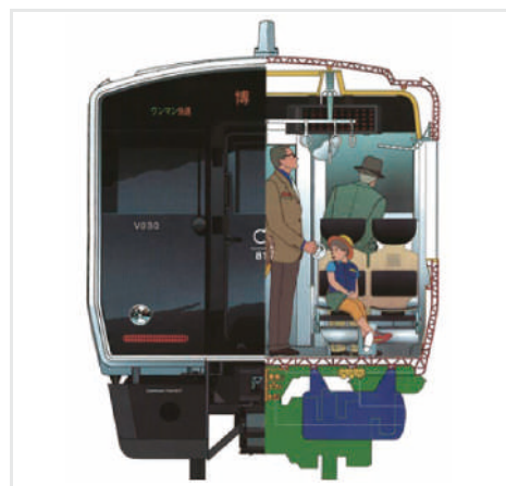
アルミダブルスキン構造 (817系)
