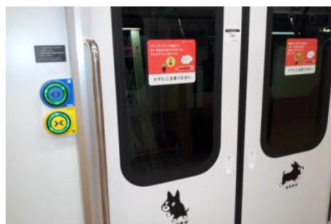
305系電車押しボタン式開閉ドア（スマートドア）
