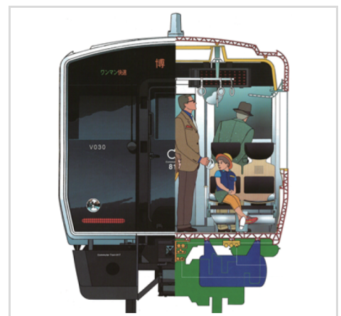
アルミダブルスキン構造 (817系)
