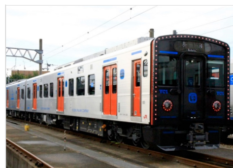
YC1系蓄電池搭載型ディーゼルエレクトリック車両
