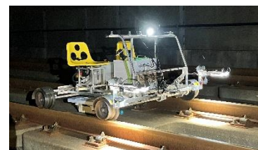
新幹線軌道モニタリング装置
