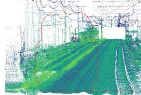
3次元点群データを用いて、「ホームやトンネルと線路」等の距離を測定
