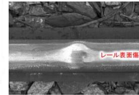
ラインセンサカメラにて、レール表面の傷や各種部材を高精度に撮影
