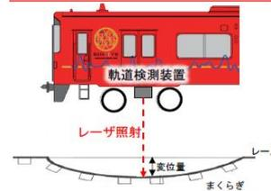
レールにレーザを照射すること等で、線路のゆがみを測定
