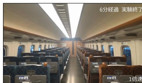
〔空調装置による換気検証（左：煙充填時の車内、右：空調装置使用6分後の車内）〕
