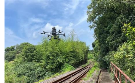
線路点検をするドローン
