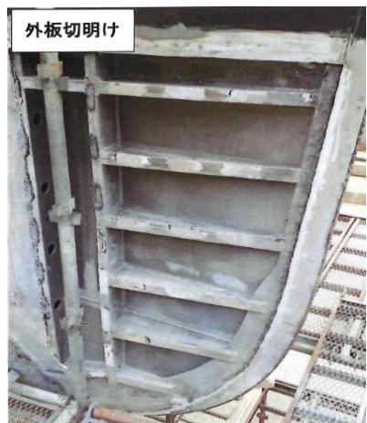
【図 5：船首部分の右舷側の外板にあるスロット溶接のためのスロット部分】
