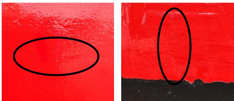
JR九州高速船は、この後も、月に1~2回程度の頻度で、他の作業のためにボートを出したついでに船首右舷部分の様子を確認するといった簡易な作業を数回ほど行ったところ、2024年2月20日に確認された喫水線の上部のうっすらとしたひび割れが次第にはっきりとしていく様子が確認されたが、浸水の原因として特定されるには至らないままであつ
